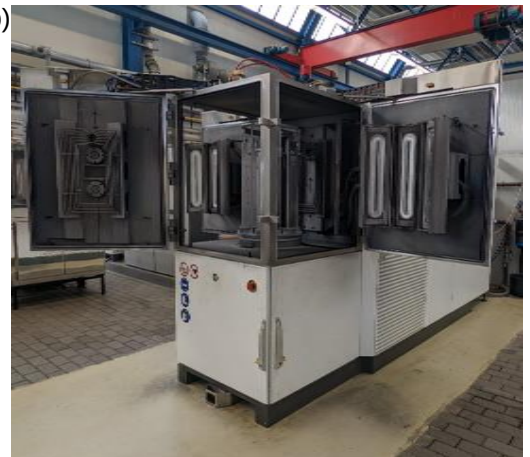
Abbildung: (a) Beispielhafte Reibkurven bei RT und 700 °C und (b) geöffnete PVD-Anlage (CemeCon, CC800/9 Custom)
