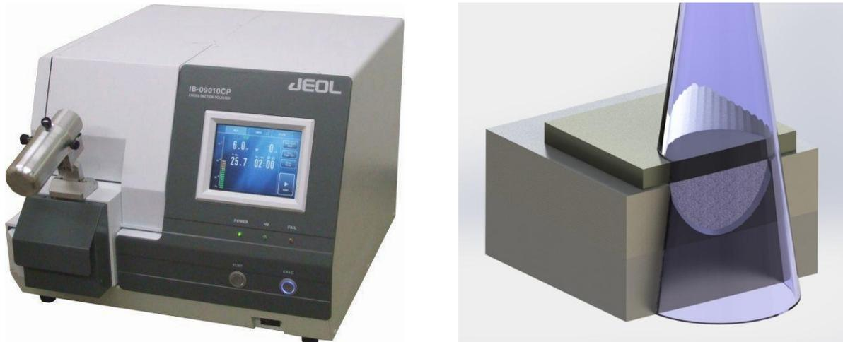
Abb. 3.5.5-1: JEOL Cross-Section-Polisher (links) und Funktionsweise der Ionenpolitur mittels nicht fokussiertem Ionenstrahl mit Maskierung (rechts). Die Probe wird mit einem Wolframblech so abgedeckt, dass zwischen 20 und 100  $\mu\text{m}$  der Probe darunter hervorschauen. Der Ionenstrahl sputtert dann von oben Material ab. Die Maske schattet die Probe teilweise ab, sodass ein glatter Bereich von ca. 1,5 x 1,0 mm entsteht, in dem das Gefüge freigelegt wird.
